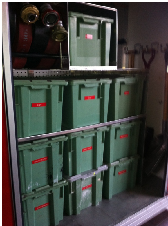
Backar med absorbentmaterial för uppsugning av flytande ämnen.
