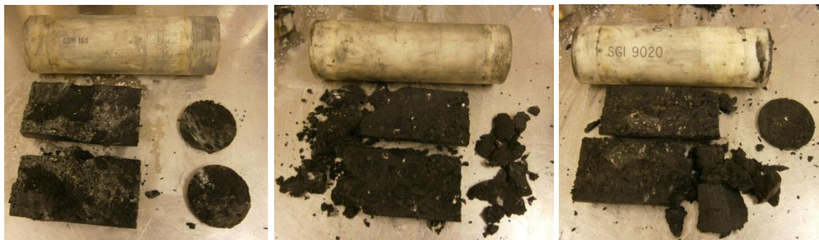
Bild 3.1: Foto på de prover som sändes för permeabilitetsanalys via CRS-ödometer till MRM. Det material som är på bilderna är det material som var kvarvarande av proverna efter analys. Provet i mitten (provrör 40) var det prov som hade högst permeabilitet och det prov som hade minst andel mesa. Foto Nanna Stahre.
