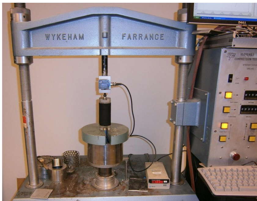
Bild 2.11: Uppställning och tryckning av grönlutslam vid enaxliga tryckförsök. Foto Nanna Stahre.
