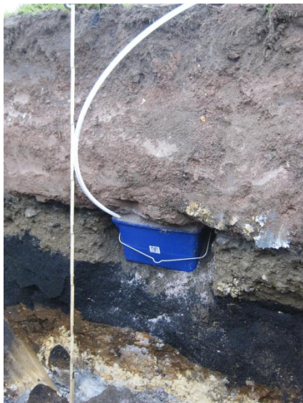
Bild 2.7: Lysimeter 4. Brunt lager är skyddskikt av morän, det lite mera rostfärgade bruna lagret är flygaska, det mörkbruna lagret (som lysimetern ligger i) är bärlager, svart lager är järnsand, rostbrunt lager i nederkant på bild är oxiderad anrikningssand och grått lager som är i bildens underkant är ooxiderad anrikningssand. Foto Maria Mäkitalo.
