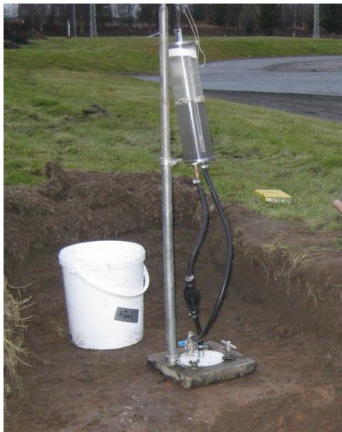
Bild 2.6: Vattenvolymetermätning i flygaskaområdet (mätningen gjordes i grop 3). Foto Maria Mäkitalo.
