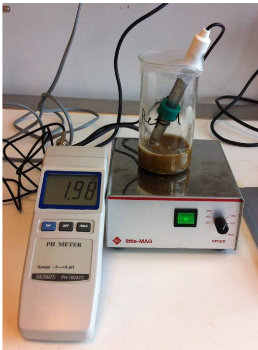
Bild 2.8: Försöksupställning för mätning av pasta pH på anrikningssand från referensområdet. Foto Nanna Stahre.
