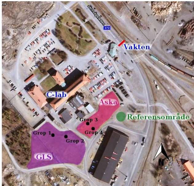
Figur 1.3: Karta över området för pilotstudien. Grop 1 motsvara profil 1, grop 2 motsvarar profil 2, grop 3 motsvarar profil 3 och grop 4 motsvarar profil 4. I bilden är GLS är en förkortning för grönlutslam, och aska är en förkortning för flygaska. I referensområdet fanns inget tätskikt utan endast anrikningssand täckt med ett ytterst tunt lager grovgrus. Gropen där referensprofilen är tagen ligger mitt i markeringen för referensområdet.
