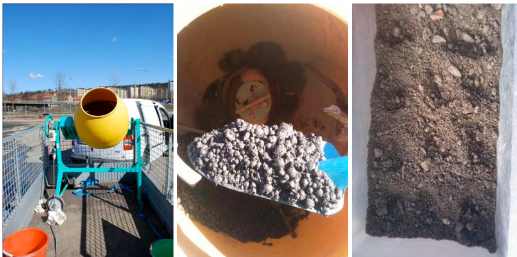
Figur 10. Bilden längst till vänster visar cementblandaren som användes för homogenisering av jordmaterialet. Bilden i mitten visar de hårda kulorna som bildades under timmen som homogeniseringen av serie A pågick. Längst till höger visas provtagningen i baljan efter homogenisering i cementblandare, med 3*4 delprover till ett samlingsprov.
