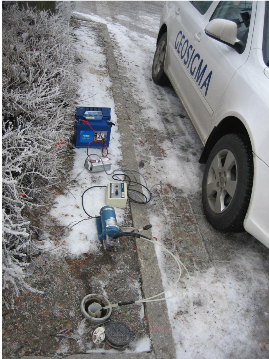
Figur 6-4 Mätuppställning för utspädningsmätning.
