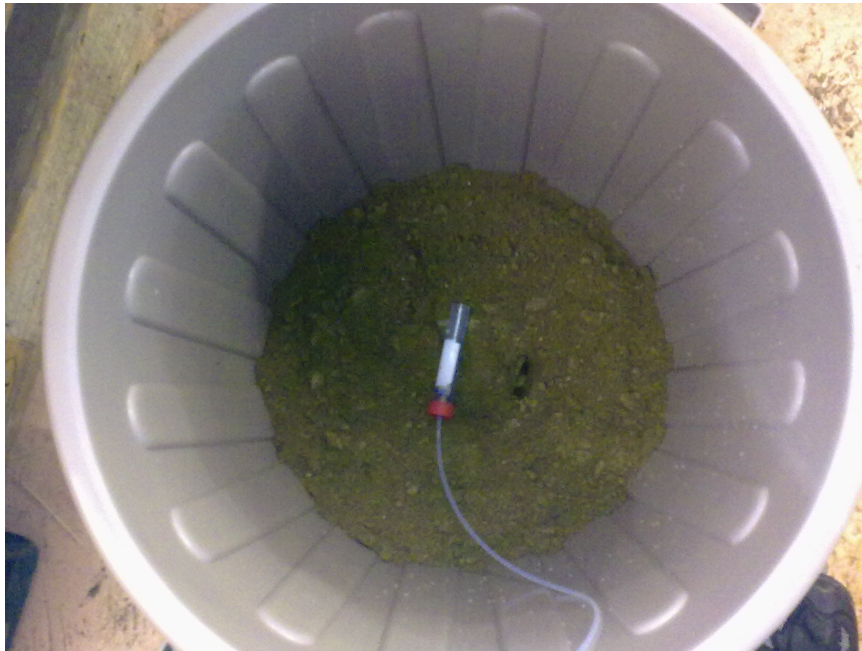
Bild 3 Mixad avfall och additiv i tunna med första lysimeter på plats.
