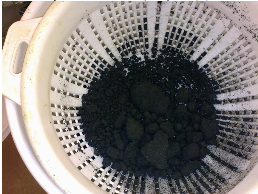
Bild 4 Bortsorterade grovfraktioner av LD-sten
