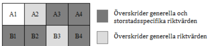
Figur 1. Fiktiv bild över provtagning med rutnät. De rutor som där det finns halter som överskrider riktvärden klassas som förorenade och schaktas bort. Ytan är den samma för samtliga rutor (exempelvis 400 m 2 ) och rutnätet är vanligen indelat i djupinterval (ex 0-0,5m), vilket ger en volymangivelse för vardera rutan.
