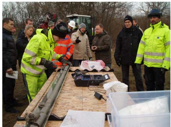
Jordprovet delas på mitten för mätning av porgaser och uttag av jord från ej korskontaminerad jord.
