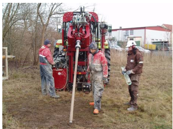
Efter upptagning vinklas kolven upp för att kunna ta ut jordprovet.
