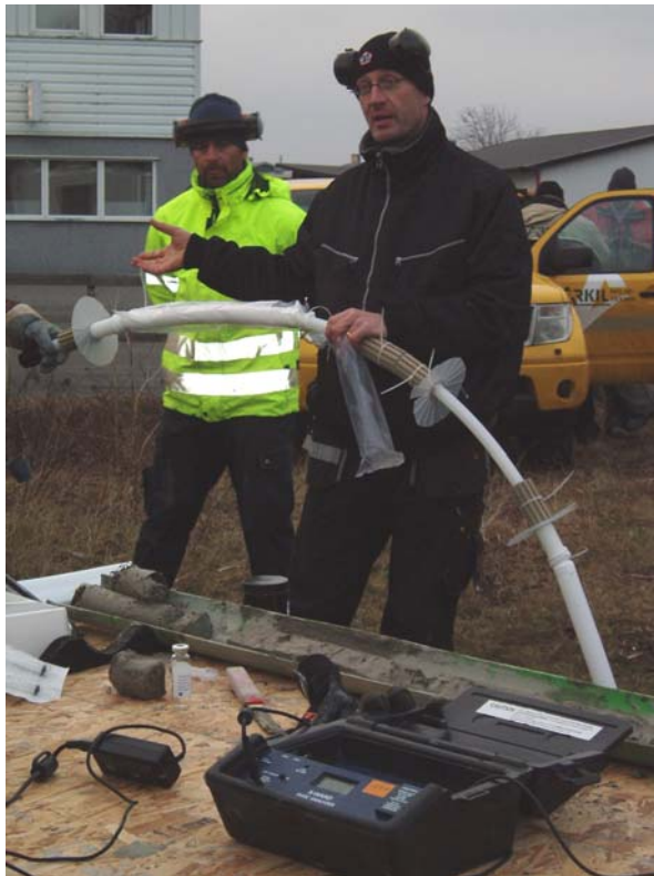
Visning av CMT-slang som försetts med filter och bentonit.
