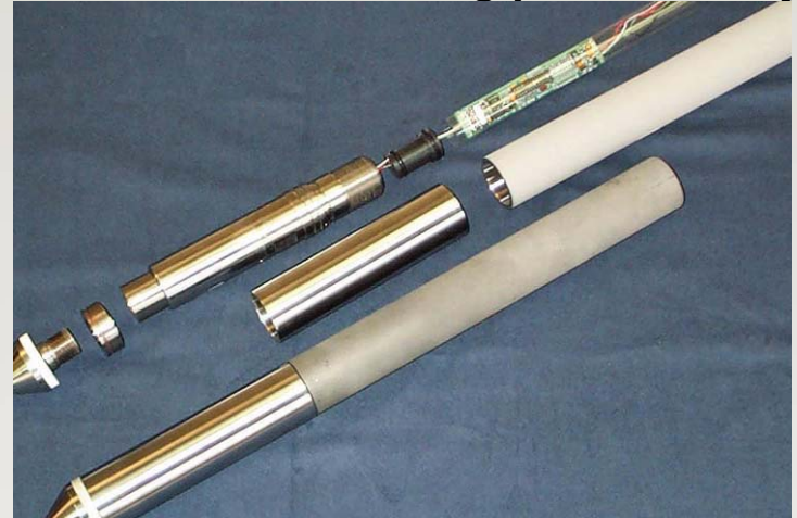
CPT-sonde fra ARA til måling af spidsmodstand, friktion og porevandstryk
