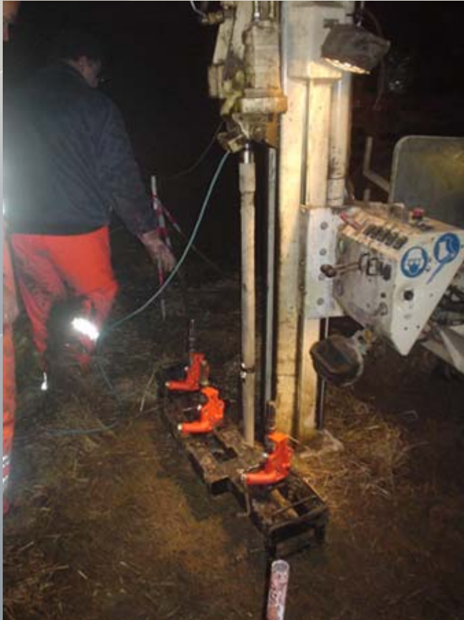
Forankring af Geoproben og CPT sonde klar til nedpresning
