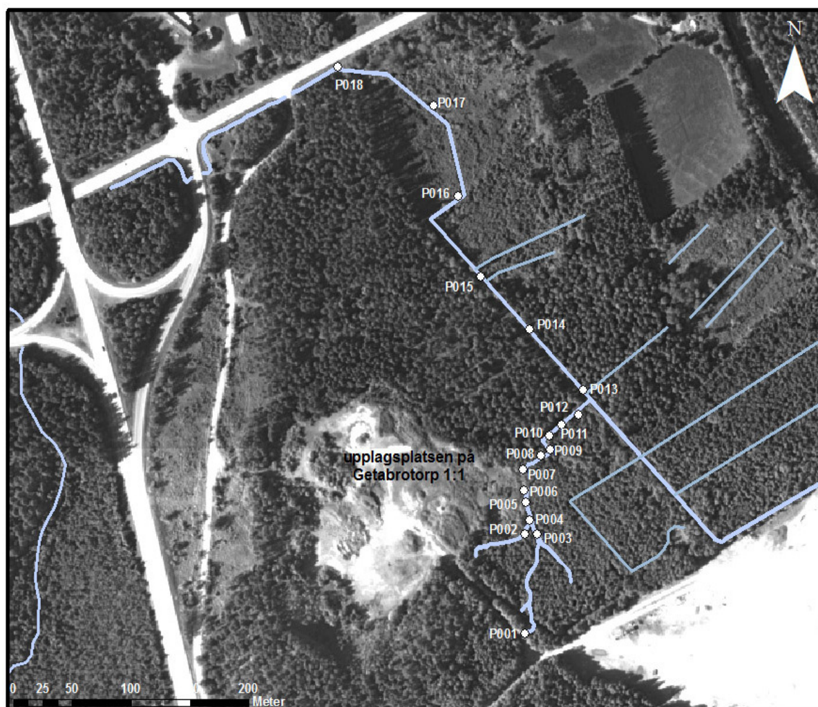
Figur 2: Kartan visar vattendragen runt upplagsplatsen på Getabrotorp 1:1 i ljusgrått och de 18 punkter i vattendraget där ytvatten och sediment provtogs den 28 och 29 april 2010 (flygbild Lantmäteriet 2010 B).
