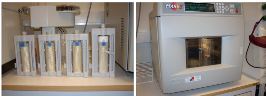
Figur 5. Syrauppslutning med mikrovågsugn.
