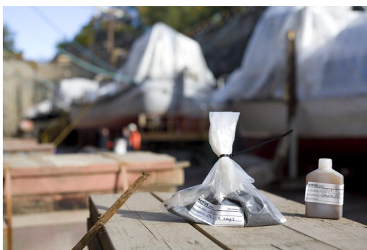
Bild 5. Spolvattenprov i plastflaska och blästermedlet i påse uppställda på ett kölblock i GV dockan. Foto: Dick Lyhammar.
